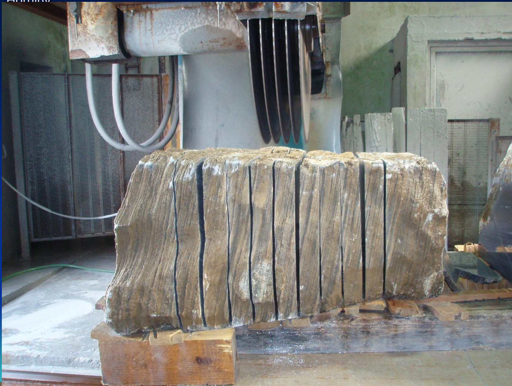
řezání bloku kotoučovou pilou
